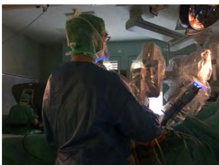
Abb. 2: Darstellung des Aufbaus des da Vinci® Surgical System: der Chirurg (links hinten im Bild) führt die Operation mittels Bedienung der Roboterarme durch, während der Assistent steril am OP-Tisch unterstützt.
