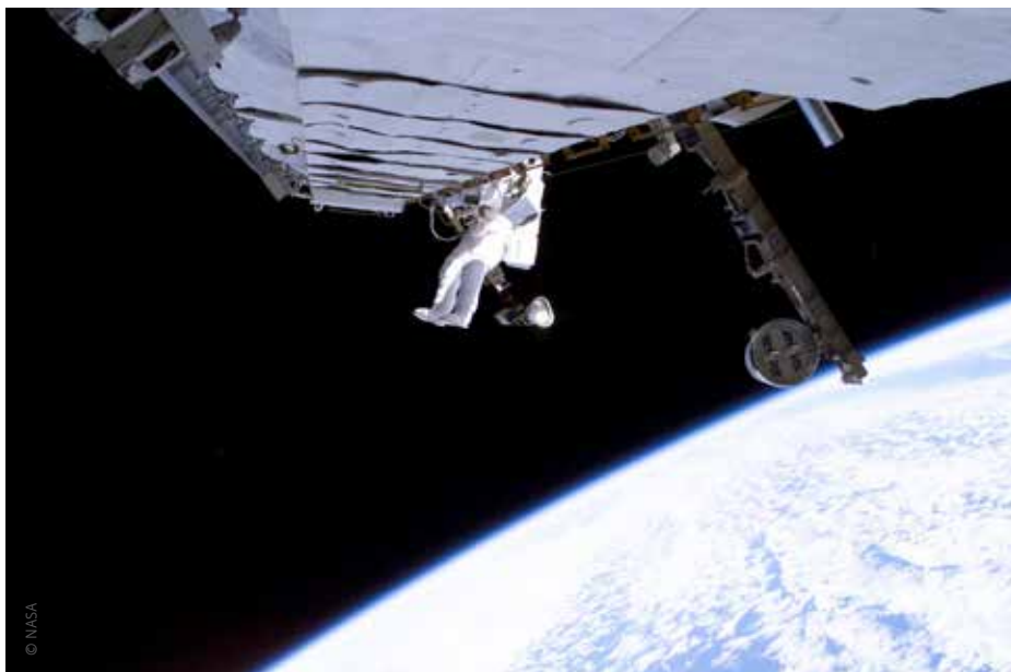
Abb. 3: Der ESA-Astronaut Thomas Reiter, Expedition 13 Flugingenieur 2, arbeitet am 3. August 2006 während eines 54-minütigen Weltraumspaziergangs an einer Kühlleitung am S1-Fachwerk der Internationalen Raumstation. Der Weltraumspaziergang war Teil seiner Astrolab-Mission, der ersten Langzeitmission der ESA zur Station.
