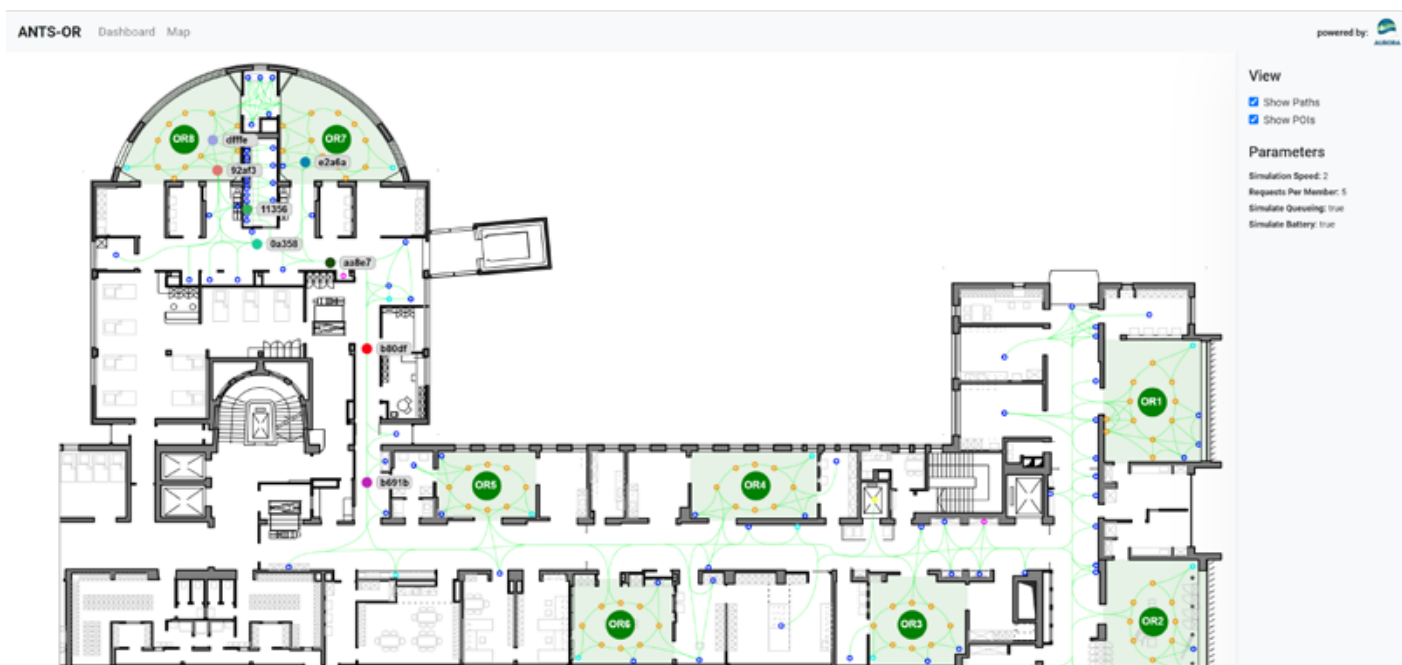
Abb. 3: Im BFS-Projekt AURORA (BFS AZ-1409-19) entwickeln wir derzeit ein mobiles Roboter-Assistenzsystem, das u. a. in einer virtuellen OP-Umgebung optimiert und validiert wird. Die Abbildung zeigt in diesem Zusammenhang die 2-D-OP-Simulation mit den einzelnen OP-Sälen und Arbeitspunkten und den Arbeitspfaden der als roten Kreis gezeichneten Roboter. (© Lukas Bernhard, AG MITI, TU München)
