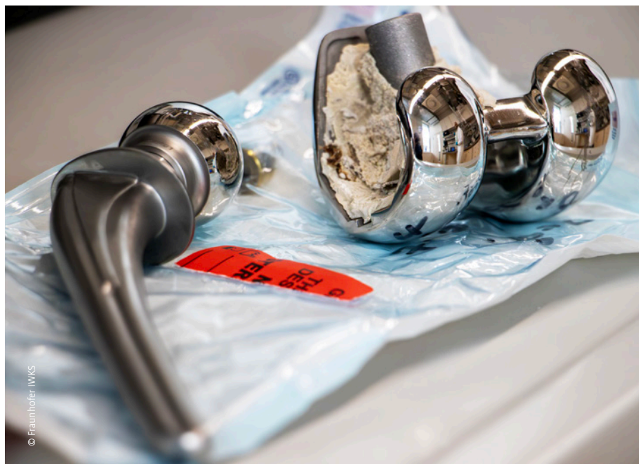
Abb. 5: Darstellung modularer Endoprothesenkomponenten (links: Hüftendoprothese, rechts: Knieendoprothese mit Anhaftungen von Knochenzement)
